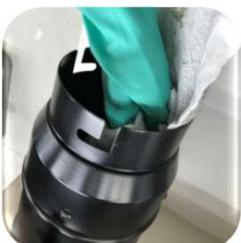
ネジを緩め、ダンパーを本体から取り外し、中性洗剤を含ませたタオル、スポンジ、ブラシなどでダンパーの内側を清掃する
